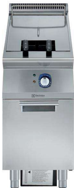
391337 (E9KKGDBAMCA) Fritéza, elektrická, 1x23L, "V" tvar vany s tělesy mimo vanu, 2x koš, 1/2 modul 400mm. Teplotní rozsah 105°-185°C, podestavba uzavřená pravými dvířky
